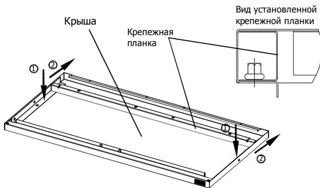
1. Установите крепежную планку под задний гиб крыши, так чтобы отверстия в крыше совпали с резьбовыми отверстиями заклепок, согласно рисунку
